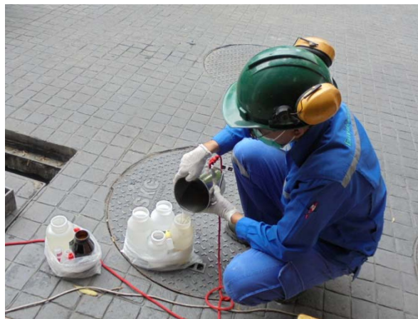
รูปที่ 3.1-2 แสดงการเก็บตัวอย่างคุณภาพน้ำทิ้ง บริเวณปลายท่อรวมของอาคาร A และ B (ระหว่างเดือนมกราคม – มิถุนายน 2566)
