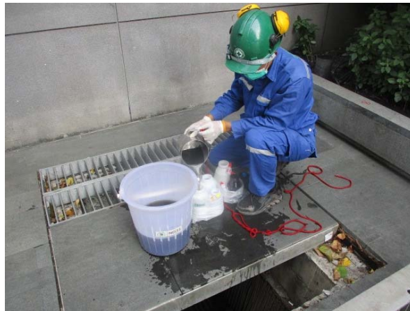
รูปที่ 3.1-2 (ต่อ) แสดงการเก็บตัวอย่างคุณภาพน้ำทิ้ง บริเวณปลายท่อรวมของอาคาร C และ D (ระหว่างเดือนมกราคม – มิถุนายน 2566)
